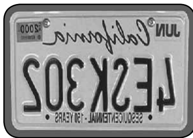
IMMAGINE INVERTITA DA SINISTRA A DESTRA VISTA CON UN PRISMA DIAGONALE STELLARE SU UN TELESCOPIO RIFRATTORE O SCHMIDT-CASSEGRAIN
